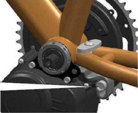
Utilisez une clé Allen de 6 mm pour serrer la vis M8 au couple d'environ 10 Nm
