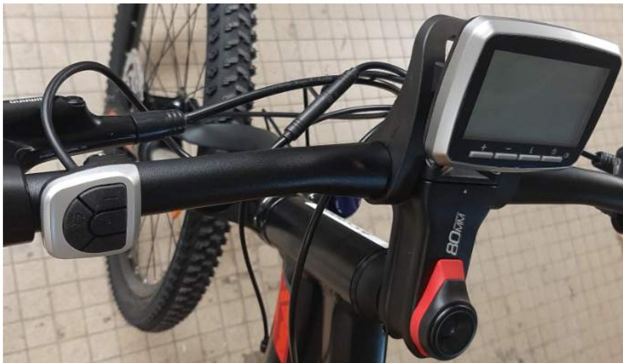
La console et son satellite peuvent être installés sans aucun démontage des poignées / leviers de freins.
