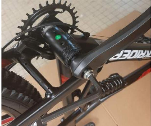
Pour extraire la manivelle, vissez à fond l'extracteur dans le filetage femelle de la manivelle. Tout en tenant le corps de l'extracteur avec une clé plate, serrez l'écrou de l'extracteur. Il faut généralement forcer un peu, puis la manivelle sort.
