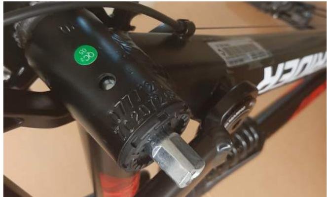
A l'aide d'une clé plate ou d'une clé à molette, desserrez l'écrou.
