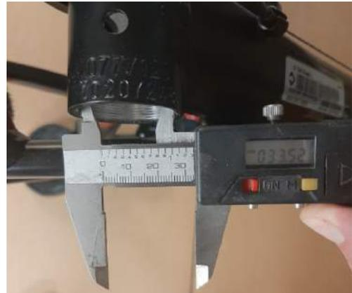
Mesure de la largeur du boîtier:
