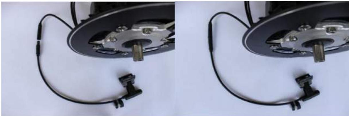
En option, vous pouvez également utiliser la sortie 6v/3W pour éclairage (équivalent à une dynamo de roue, ne pas mettre de lampe plus puissante - risque destruction contrôleur moteur !) pour alimenter vos feux avant et/ou arrière. La prise et les câbles nécessaires sont fournis dans le kit. La prise se connecte sur la sortie libre du capteur de vitesse.
