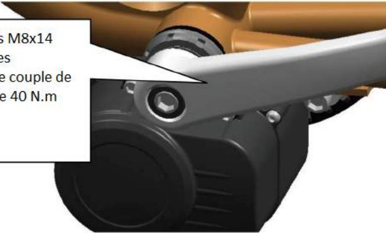
Utilisez les vis M8x14 pour serrer les manivelles. Le couple de serrage est de 40 N.m
