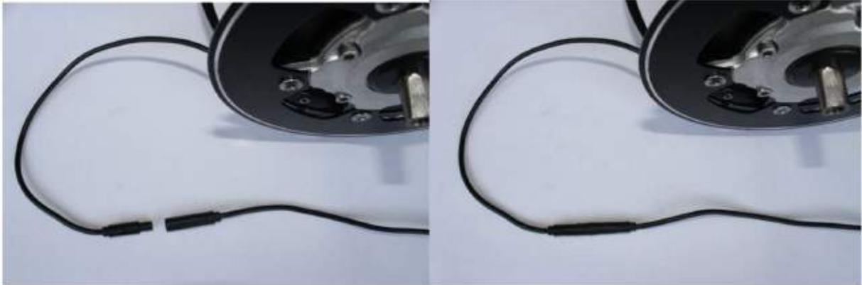
Puis le câble du capteur de vitesse, qu'il faut relier là aussi au câble du moteur.
